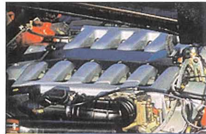
Isdera 112 i, V-12, 48 válvulas, 408 CV
